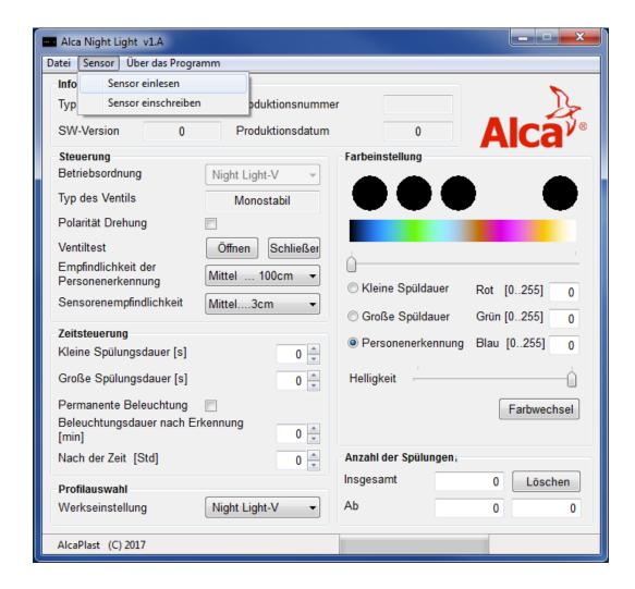
Das Anzeigen bedeutet, dass der Treiber ordnungsgemäß installiert wurde. Um die Parameter abzurufen, wählen Sie **Sensor / Sensor einlesen**. Benutzer zugängliche Parameter werden im Hauptfenster eingestellt, das in mehrere Abschnitte unterteilt ist. Die untere Statusleiste zeigt den Fortschritt des Datenabrufs an.
